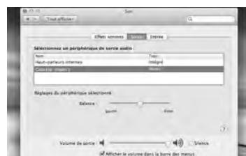
Sélectionner l'onglet « Sortie » puis la ligne Stream 3. Régler le volume de sortie sur la position maximum. Fermer la fenêtre.
