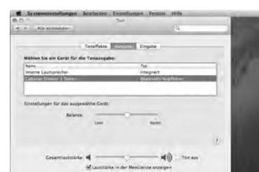
Wählen Sie unter „Ausgang“ „Stream 3“. Stellen Sie die Lautstärkeinstellung ganz nach rechts. Schließen Sie das „Sound“-Menü.
