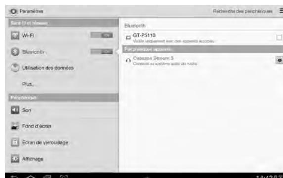
Le processus de connexion est lancé. Si le message «Connexion...» n'apparaît pas, vérifiez qu'un autre appareil n'est pas déjà connecté au Stream 3. Déconnecter cet appareil et appuyer une nouvelle fois sur "Cabasse Stream 3".
